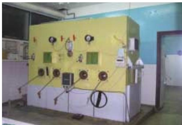
ベトナムのグラト研究所内Tc-99m製造用鉛セルの外観
