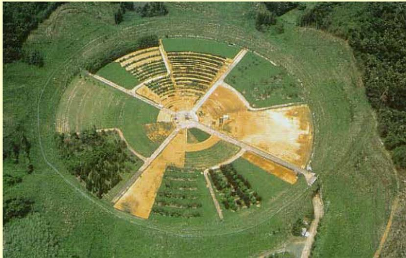
ガンマフィールド（植物の品種改良のための世界最大の照射施設；原子力平和利用のシンボル）：半径100mの円形で、中央に88.8Tbq（テラベクテル）の $^{60}\text{Co}$ （コバルト60）線源を入れた照射棟があり、周囲を高さ8mの防御用の土手で囲った野外緩照射施設。
