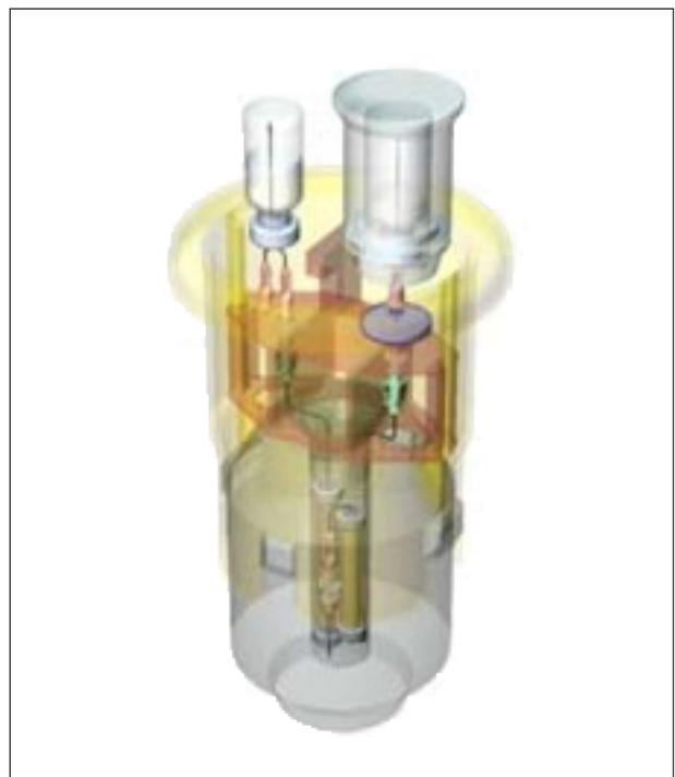
PZCを用いた $^{99}\text{Mo}$ - $^{99m}\text{Tc}$ ジェネレーターの透視図
