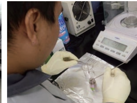
写真左及び中央：土壌有機物の計量、写真右：土壌サンプルの燃焼
