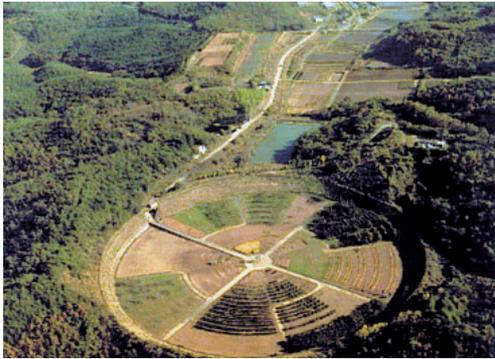
写真3：世界最大のガンマーフィールド（中央の塔から出た放射線が周りの植物に突然変異を発生させる）
