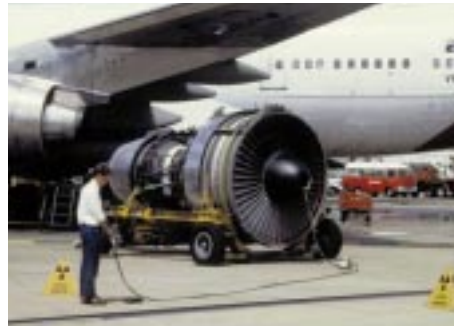
日本では、放射線の産業利用について知りたいと思う高校生の割合は他国と比べて低い。写真は放射線による航空機エンジンの非破壊検査。(写真提供：豪・原子力科学技術機構)
