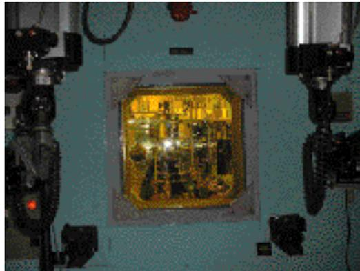
写真1 インドネシアBATANの遮蔽セル内に設置されたローディングマシン
