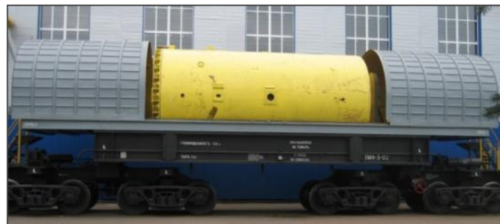
Тук и железнодорожный транспортер для перевозки ОЯТ на хранение
